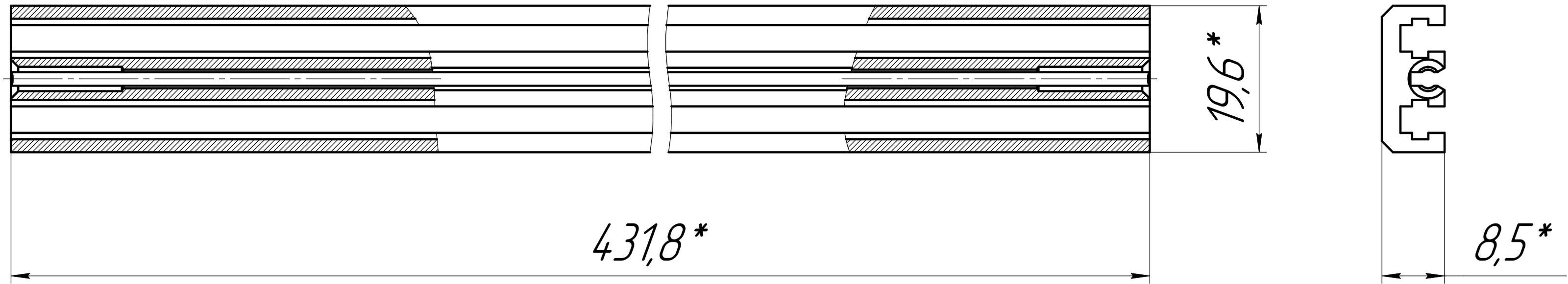
*Рисунок 1. Внешний вид и профиль релинга заднего среднего*
